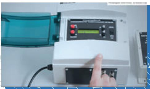
Демонстрация подключения датчиков Сигма-03.Д-SF6 (элегаз) к информационному блоку.
