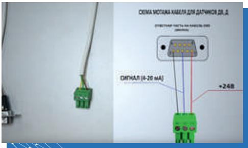
Образец пайки проверочного кабеля, для датчиков газоанализатора универсального Сигма-03.
