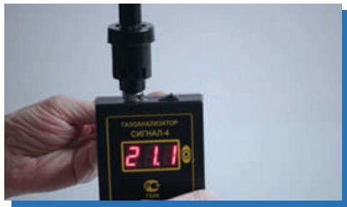
Регулировка газоанализатора взрывоопасных паров Сигнал-4КМ (кислород/любой тип ВОГ)
