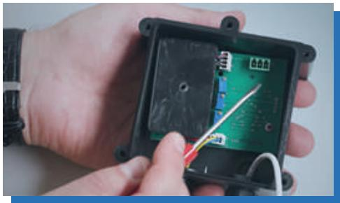
Обзор подключения датчика ДВ, ДЭ к информационному блоку газоанализатора Сигма-03.ИПК
