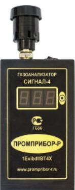
**Применение:** Предназначен для индивидуальной защиты персонала. Данный прибор позволяет одновременно контролировать дав взрывоопасные концентрации (ДВК) горючих газов, предельно допустимые концентрации (ПДК) токсичных газов в воздухе рабочей зоны. Измерение и подача аварийной сигнализации при повышении заданного уровня концентрации взрывоопасных и горючих газов, предельно допустимых концентраций (ПДК) токсичных газов в местах отбора проб.
